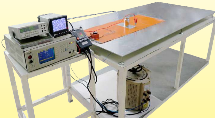
Messgeräte für den Gesamtleckstrom im heißen Zustand
